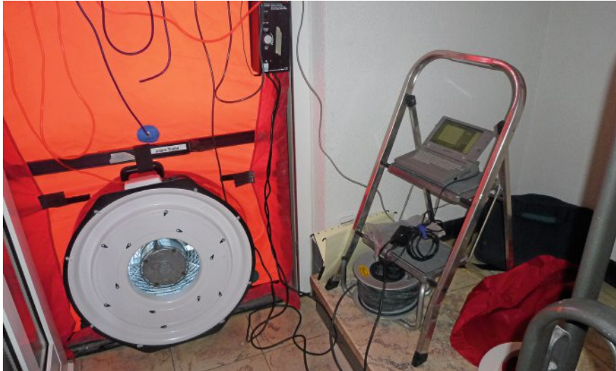
Der luftdichte Folienrahmen samt Ventilator ist das Kernelement des „Blower-Door“-Tests.
