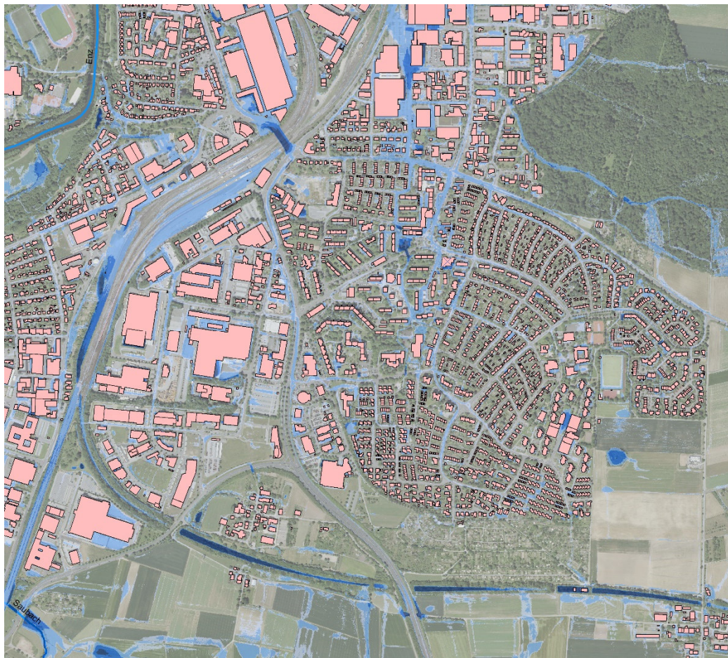
Abbildung 11: Übersicht der Überflutungstiefen im Bereich Gewerbegebiet Laiern und Buch bei einem außergewöhnlichen Ereignis
