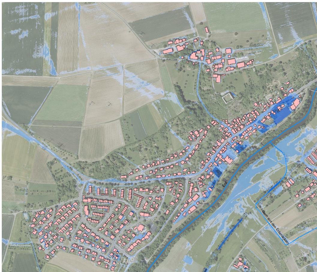
Abbildung 17: Überflutungstiefen in Untermberg bei einem außergewöhnlichen Ereignis
